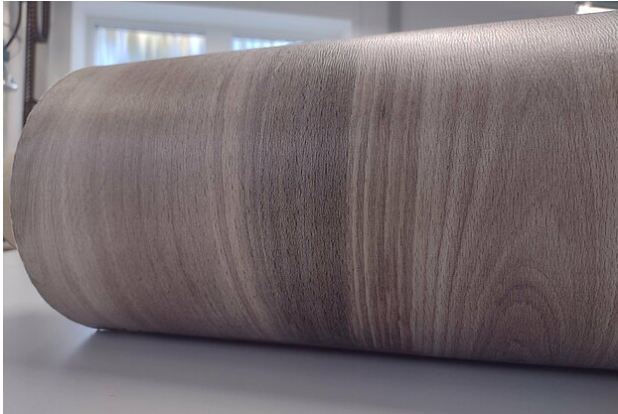
Abb. 1: An kontinuierlich arbeitender, kleintechnischer Anlage hergestellter PUR-Bodenbelag mit organozinnfreier, biobasierter Deckschicht
