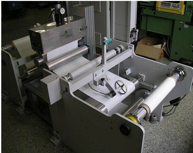
Abb. 1: DBE-Anlage (kontinuierliche Vorbehandlung/ Präkursorapplikation)
