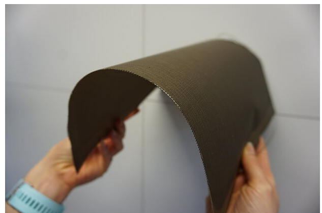
Abb. 2: Silazan-Silicon-Schicht auf Basaltgewebe
