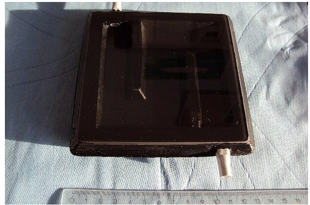
Abb. 2: Musterbaugruppe mit einer Grundfläche von 120 x 120 mm 2 sowie im Schäumungsprozess inkludierten Anschlüssen
