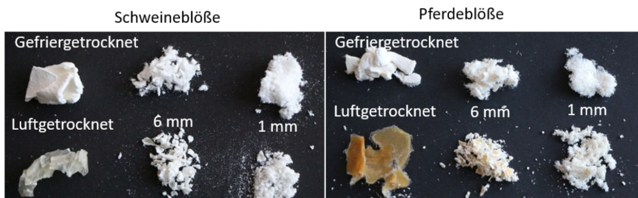
Abb. 1: Hautpulver aus Schweine- und Pferdeblößen nach verschiedenen Trocknungsverfahren in verschiedenen Zerkleinerungsstufen
