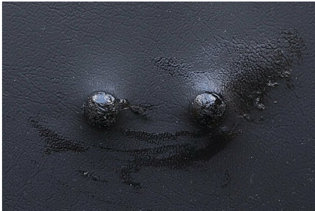
Abb. 1a: Auswirkungen der Medienbehandlung (+ Kratzbeanspruchung): PUR-Kunstleder (für Polstermöbel) mit Oleinsäure
