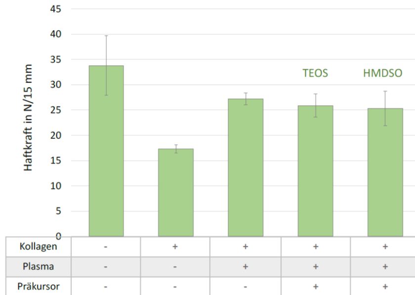
Abb. 1: 90°-Peeltest an beschichteten PCL-Folien. Gemessen wurde die maximale Haftkraft, die beim Abziehen des Klebebandes Duplocoll aufgetreten ist.
