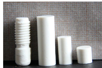
Abb.: Am FILK hergestellte Formkörper aus Kollagen-Silikat-Kompositmaterialien
