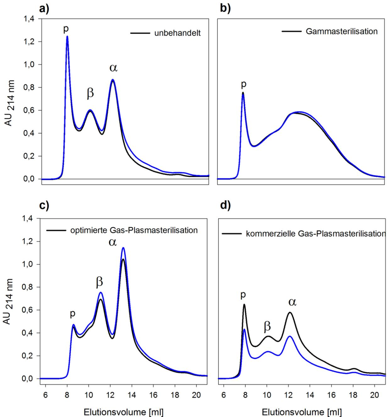
Gel-Permeationschromatographie des (a) unbehandelten, (b) gammasterilisierten, (c) im optimierten Gas-Plasma-Verfahren sterilisierten und (d) im kommerziellen Gas-Plasma-Verfahren sterilisierten Kollagenmaterials. Die Banden  $\alpha$  und  $\beta$  stehen für das Kollagenmonomer und -dimer und p steht für die höhermolekularen Anteile der Probe.
