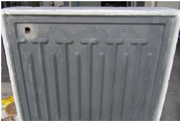
Abb. 1: Schaumglasdemonstrator (Grundfläche 500 x 500 mm 2 ) mit Strömungsprofil für die Anwendung als Solarthermiekollektor
