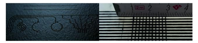
Abb. links: gedruckte leitfähige Strukturen mit einer lateralen Ausdehnung von ca. 300 µm auf einer schwarzen Substratfolie; rechts: Gitterstruktur auf einer transparenten Polyurethanfolie, mit der eine drucksensitive Sensorfolie aufgebaut wurde
