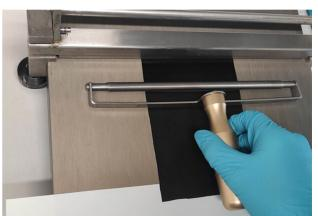
Lackauftrag im Labormaßstab mittels Spiralrakel.
