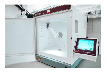
Mikrowellensystem für die Synthese der PLA-Copolymere.
