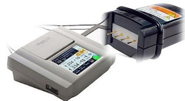
Abb. 2: Messung des Oberflächenwiderstands mit 4-Punkt-Elektrode
