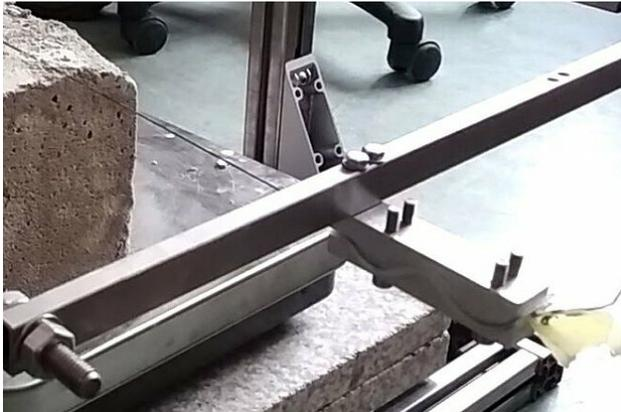
Abb. 1: Laborschneidanlage mit spezieller Einspanntechnologie für Glasfaserdrähte
