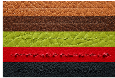
Abb. 2: Mit derselben Kratzspitze erzeugte Erscheinungsformen von Kratzern auf Bezugsmaterialien
