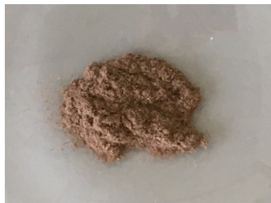
Abb.2: Durch Kaltmahlen erzeugte Keratinpartikel: erster Mahlgang
