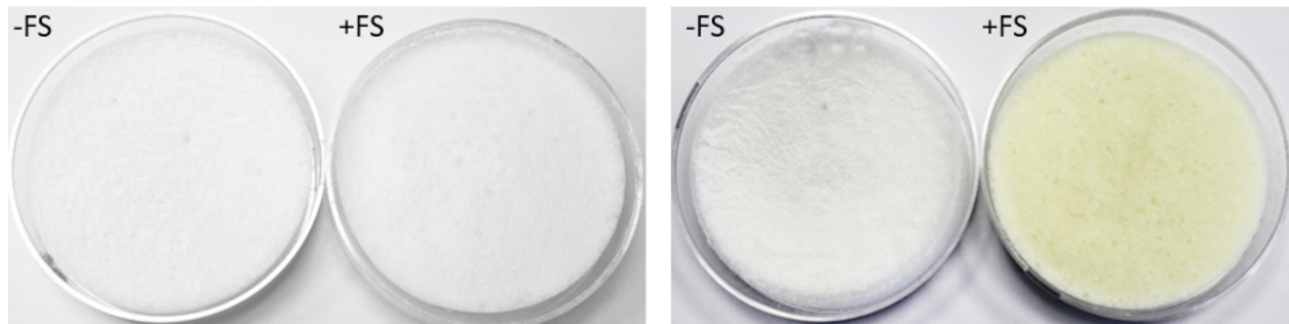
Abb. 3: Vliese mit und ohne Fettsäuren (links: nach zwei Tagen, rechts: nach sechs Monaten)
