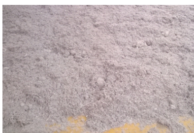
Abb. 2: Chromierte Falzspäne aus der Dickenbearbeitung
