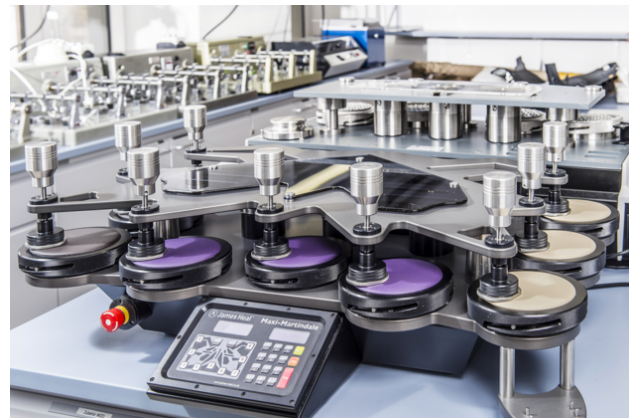
Abb. 2: Prüfung von Kunstledern mit der Martindale-Methode
