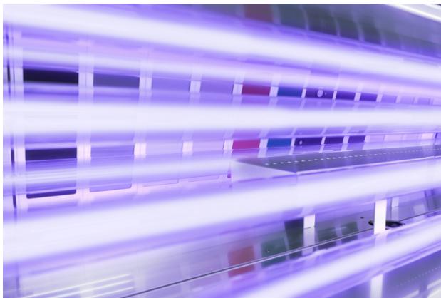
Abb. 1: UV-C-Strahlung emittierende Fluoreszenz-lampen
