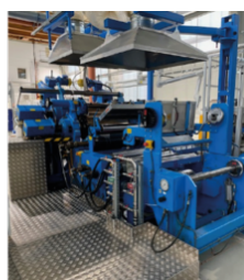
Abb. 1: Aufbringen der Mikrostrukturen mittels Heißprägen; links: diskontinuierlich (hydraulische Presse), rechts: kontinuierlich (Kalander)
