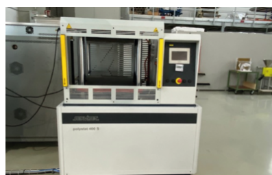
Abb. 1: Aufbringen der Mikrostrukturen mittels Heißprägen; links: diskontinuierlich (hydraulische Presse), rechts: kontinuierlich (Kalander)
