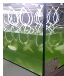
Abb. 2: Aquarientest mit limnischen Algen für Teichfolien
