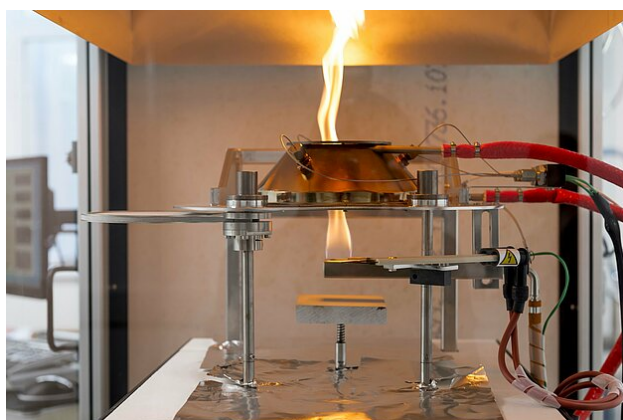
Abb. 1+2: Brandprüfungen mittels Cone-Kalorimetrie (oben) und horizontaler Brennprüfung (rechts)
