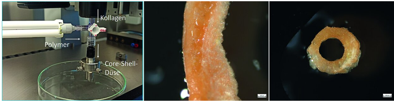
Abb. links: Darstellung des Zudosierungssystems bestehend aus 2-Komponenten-Kartusche und statischem Mischer zur Zuführung des Polymers, Kartusche mit Kollagensuspension, 2-Wege-Hahn für die Durchmischung und die Core-Shell-Extrusionsdüse. Abb. Mitte/rechts: Stereomikroskopische Aufnahmen von Längsansicht und Querschnitt eines polymerverstärkten Hohlfilaments nach der Rehydrierung. Maßstab = 200 \mu\text{m} .
