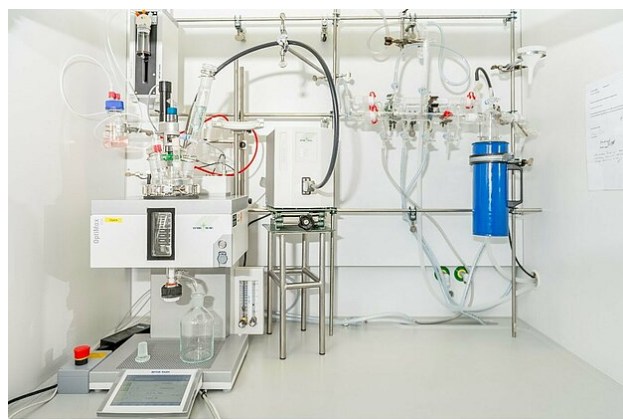
Abb. 1: Optimax-Synthesereaktor zur Durchführung der Glycerolyse
