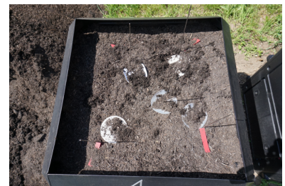
Abb. 2: Proben aus PBS-Folie und mit PBS beschichteten Textilien im Gartenkomposter
