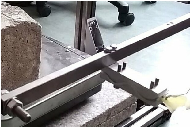
Abb. 1: Laborschneidanlage mit spezieller Einspanntechnologie für Glasfaserdrähte
