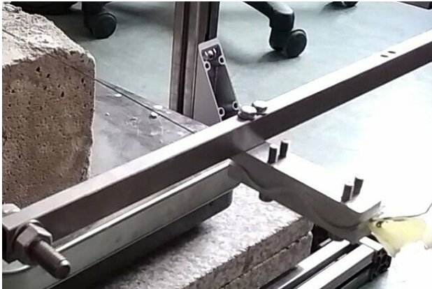
Abb. 1: Laborschneidanlage mit spezieller Ein- spanntechnologie für Glasfaserdrähte
