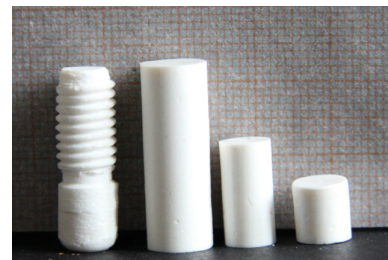
Abb.: Am FILK hergestellte Formkörper aus Kollagen-Silikat-Kompositmaterialien
