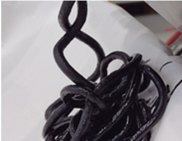
Mittels Reaktivextrusion hergestelltes TPU-CNT-Nanokomposit
