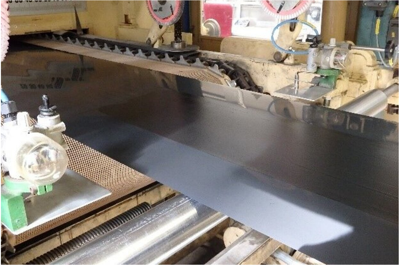
Kathodenmaterial (kontinuierlicher Nassauftrag) auf PI-Folie
