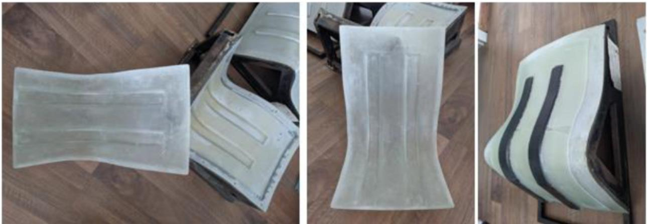
Abb.: Hergestellter Technologiedemonstrator, bei dem die Temperatur- und Drucksensoren in eine 400 mm x 600 mm große Membran integriert wurden
