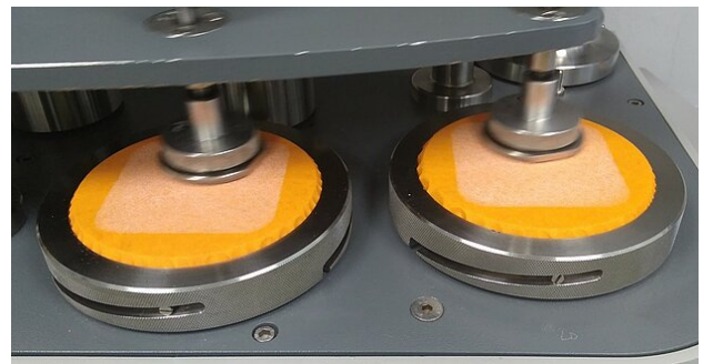
Abb. 2: Abriebprüfung lackierter PUR-Kunstleder nach DIN EN 388 gegen Sandpapier
