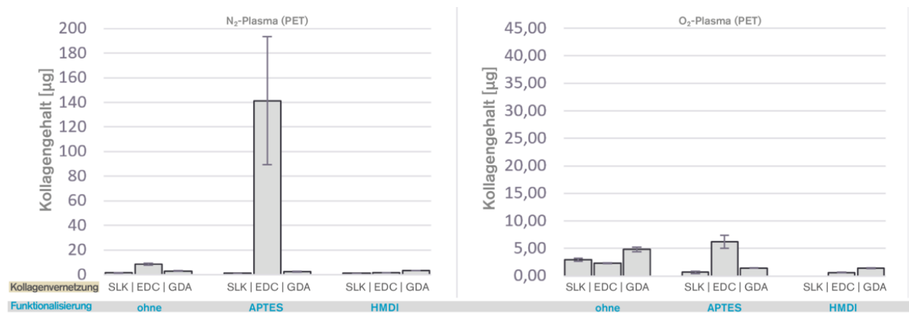
Abb. 1: Kollagengehalt der PET-Oberflächen nach Aktivierung mit Plasma und anschließender Funktionalisierung (SLK...Säurelösliches Kollagen ohne Vernetzer). Die gemessene Menge Kollagen bezieht sich auf eine Fläche von 1,1 cm 2 .
