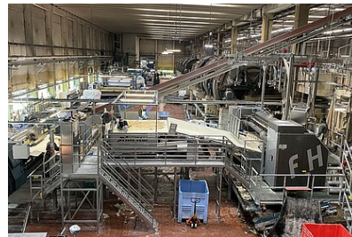
Abb. 2: Moderne Entfleisch- und Spaltlinie für Großviehhäute (Quelle: HELLER-LEDER GmbH & Co. KG)
