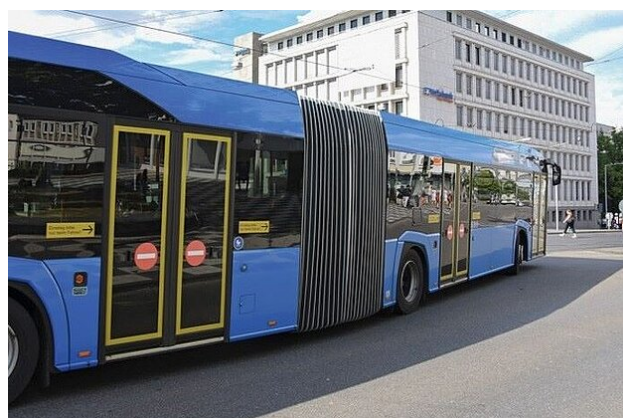
Gelenkbus, dessen Wageneinheiten durch Faltenbälge verbunden sind
