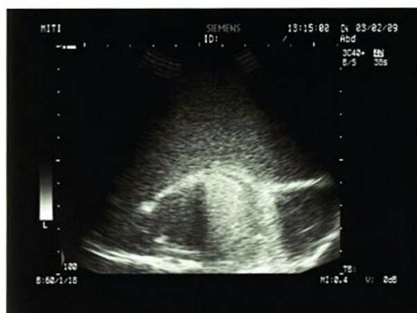
Abb. 1: Lebermodell mit Artefakten im Ultraschall
