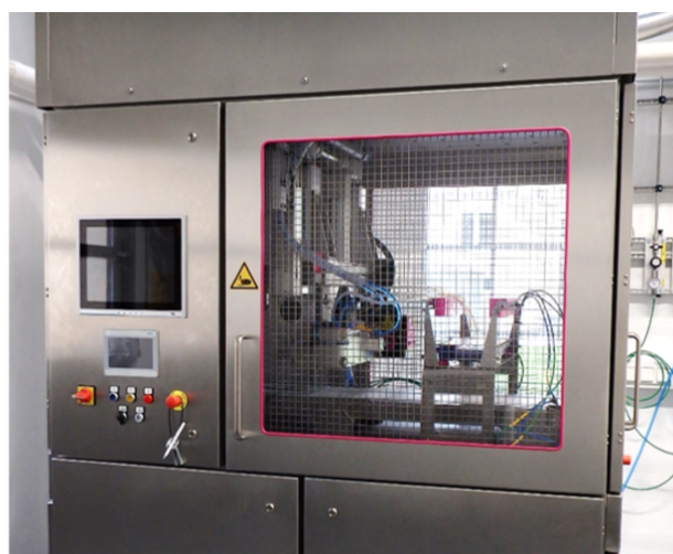
Abb. 2: Zur Abscheidung der knochenähnlichen Beschichtung wird eine Kaltplasmaanlage mit Afterglow-Technologie eingesetzt.
