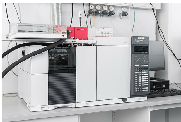
Abb. 2: TDS-GC/MS System zur Charakterisierung der Ausgangs- und Referenzmaterialien
