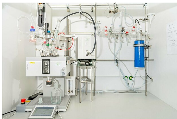
Abb. 1: Optimax-Synthesereaktor zur Durchführung der Glycerolyse
