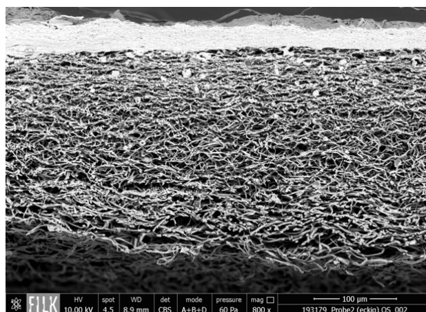
Abb. 2: REM-Aufnahme (800x) eines Pilzmycel-Composites
