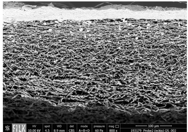
Abb. 2: REM-Aufnahme (800x) eines Pilzmycel-Composites
