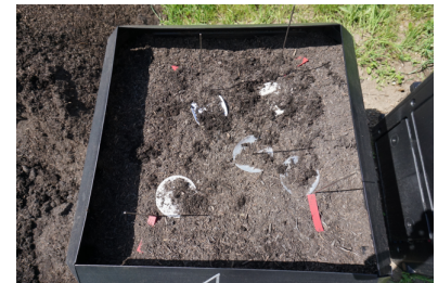
Abb. 2: Proben aus PBS-Folie und mit PBS beschichteten Textilien im Gartenkomposter
