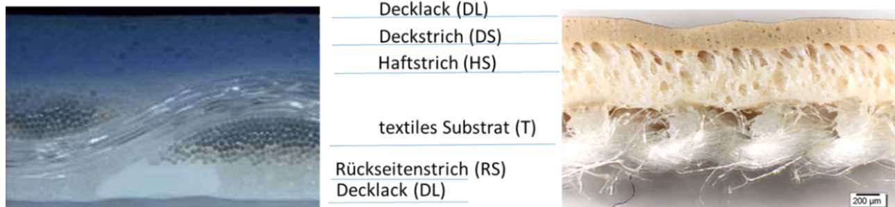
Abb. 1: Typischer Schichtaufbau für Planenmaterialien (links) und Kunstleder (rechts)
