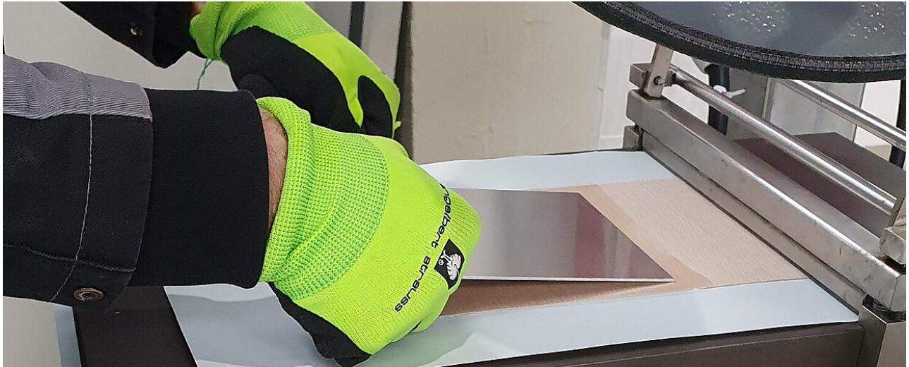
Abb. 1: Herstellung von Furnier-Aluminium-Verbunden: Auflegen einer erwärmten Al-Platte auf ein mit PUR-Hotmelt beschichtetes Furnierstück
