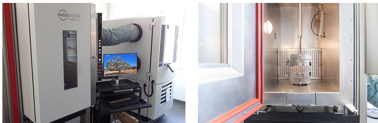
Universalprüfsystem mit angeschlossener Klimatisierungseinheit und Prüfkammer.
